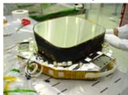
**Le miroir primaire (parabolique) reçoit la lumière traversant la pupille (de 27 centimètres). Il la réfléchit vers un second miroir (parabolique aussi), placé à l'avant et renvoyant la lumière vers l'arrière, sur le capteur.**
