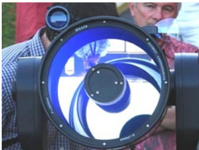
**Optique Schmidt-Cassegrain, diamètre de 254 mm, focale de 2500 mm, monture à fourche : notre Meade LX 90 est un modèle imposant (35 kilos avec le pied). Avec son rapport focale de 10, il convient au ciel profond et au planétaire. Sa monture altazimutale est pilotée par deux moteurs et une électronique «Go To». Le club a fait l'économie du GPS mais ce télescope dispose du système LNT (Level North Technology), un compas électronique servant à orienter l'instrument (le verre en haut à droite).**
