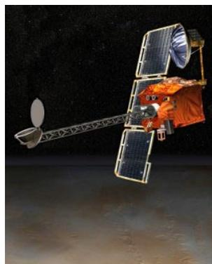
Accrochée à la sonde européenne Mars Express, mise en orbite en janvier 2004, cette longue poêle à frire porte le radar Marsis, capable de détecter de l'eau dans le sous-sol martien. Il ne reste plus qu'à la déployer
